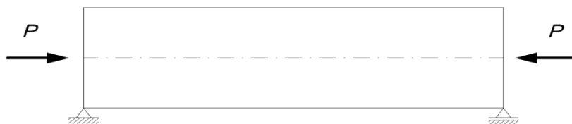
Figura 5.1: Ação do pré-esforço sobre o betão
