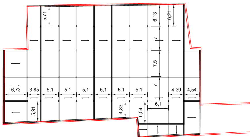
Figura 3.1: Planta estrutural do primeiro modelo, nível inferior (linhas exteriores a vermelho não pertencem ao modelo)
