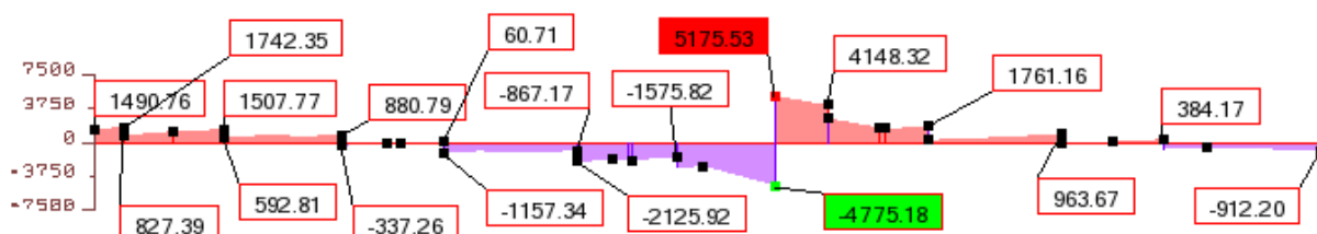
Figura 5.57: Diagrama de esforço transversal da viga B7 para ELU com pré-esforço a tempo infinito
